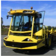
Le projet ATT hybride et électrique sans pilote a pour objectif de concevoir un véhicule de manutention logistique en zone portuaire sans chauffeur.
